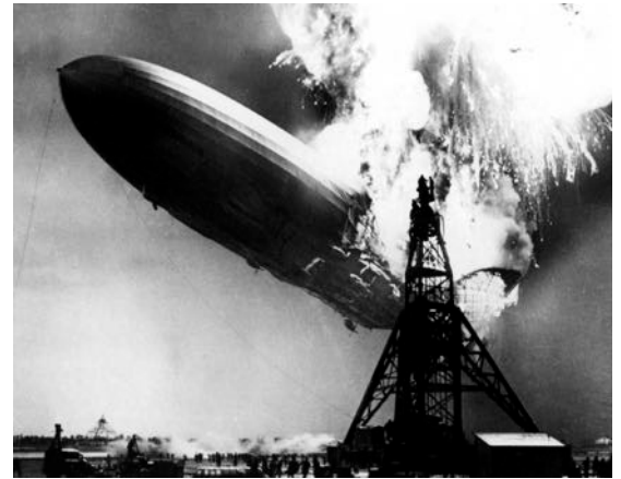
Der Zeppelin „Hindenburg“ verunglückte 1937 bei der Landung in Lakehurst (New York). Ein Funkenschlag setzte erst den Wasserstoff in Brand, dann entzündete sich auch der Dieselmotorkraftstoff. 35 der 97 Personen an Bord kamen ums Leben. Das Unglück bedeutete das Ende der großen Luftschiffe.
