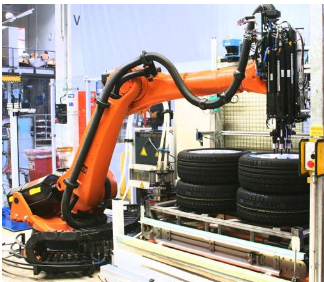
Industrieroboter. Dieser montiert die Räder am Auto.
